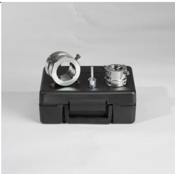
Адаптеры съемника ступицы Posi Lock упрощают снятие многих промышленных и автомобильных вентиляторов и крыльчаток нагнетателя, обеспечивая надежное соединение между съемником и ступицей вентилятора.
